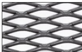
TIPO 43 - DL 43 x 10 mm PESO kg/m 2 10,5 SPESSORE 3 mm
